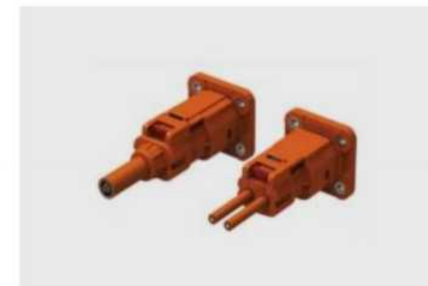
系列: HVA280高压互连 额定电流: 100A 额定电压: 1000V
